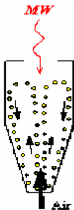
รูปที่ 10.6 แสดงหลักการทำงานของระบบอบแห้งวัสดุด้วยคลื่นไมโครเวฟร่วมกับระบบสเปาเต็ดเบด
